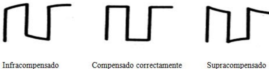
3. Utilizzare un driver non metallico per regolare il foro di regolazione della compensazione a bassa frequenza sulla sonda finché la forma d'onda cambi precisamente come nell'immagine sopra”.
