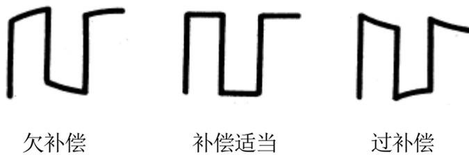
3. 用非金属质地的改锥调整探头上的低频补偿调节孔，直到显示的波形如上图“补偿适当”。
