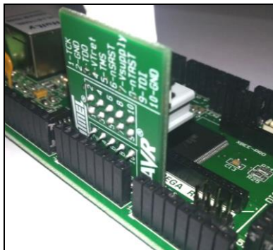
Fig. 5. Programming via SPI. [Programmazione tramite SPI]
