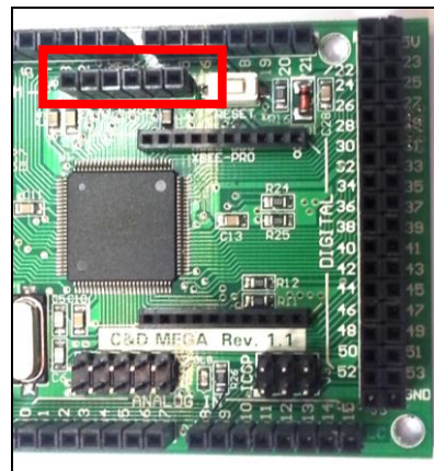
Fig. 3. Supplying power through the USB programmer. [Fornire alimentazione tramite il programmatore USB]
