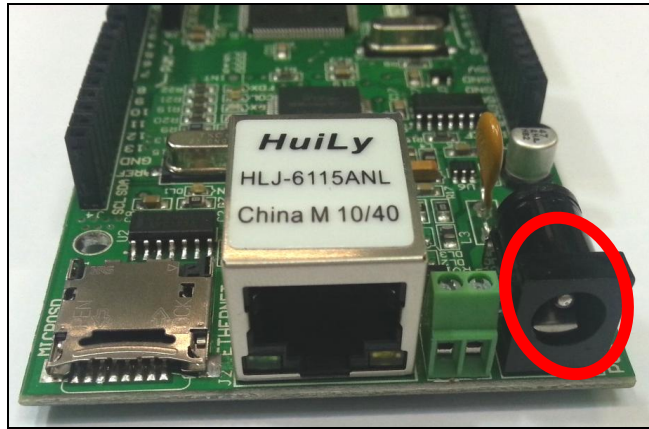
Fig. 1. Supplying power via a power adapter. [Fornire alimentazione tramite un trasformatore]
