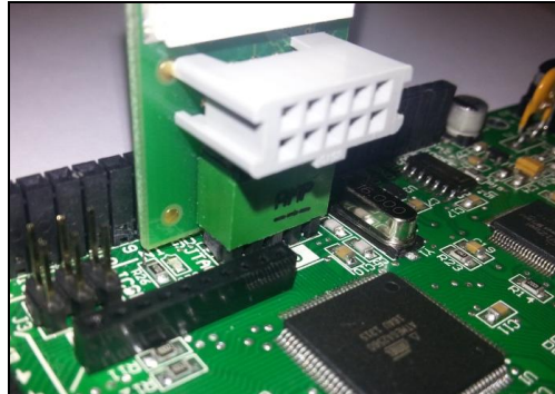
Fig. 5. Programming via SPI. [Programmazione tramite SPI]
