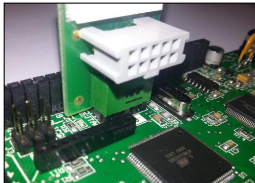
Fig. 5. Programming via SPI. [Programmazione tramite SPI]
