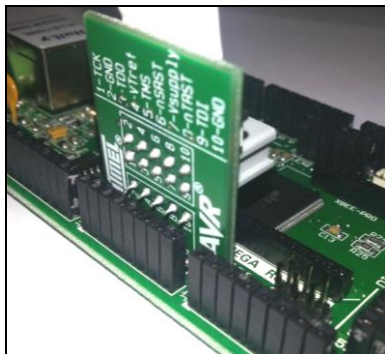
Fig. 5. Programming via SPI. [Programmazione tramite SPI]
