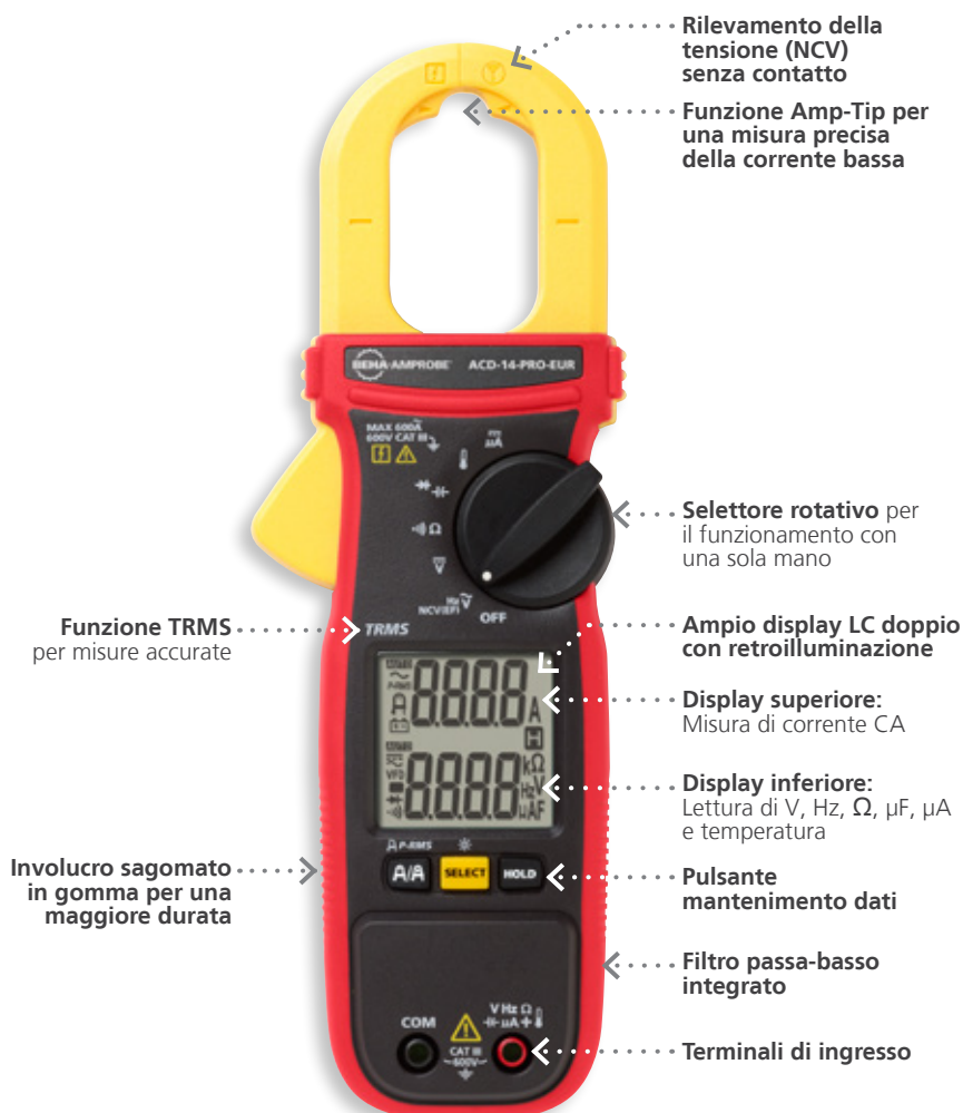
ACD-14-PRO-EUR Multimetro a pinza TRMS con doppio display 600 A
