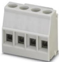
Morsetto per circuiti stampati, corrente nominale: 24 A, passo: 5 mm, numero poli: 4, collegamento: Connessione a vite con gabbia, montaggio: Saldatura ad onde, direzione di collegamento conduttore/scheda: 0 °, colore: grigio chiaro. Articolo con uscita pin laterale
