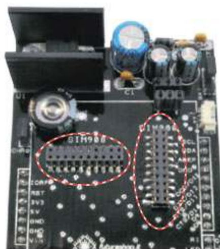
Fig. 3 - Strip per il collegamento dei nuovi moduli che equipaggiano i chip della famiglia SIMCom in versione compatta.
