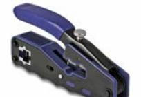
La pinza è ideale per la crimpatura di spine modulari RJ45 schermate con clip di scarico della trazione, ma anche di spine RJ45 standard. Questo può essere regolato tramite una vite di regolazione. Taglierina e spellafili integrati. La pinza dispone di due lame sul manico per tagliare e spellare. Una delle due lame è regolabile singolarmente in altezza con una vite.
