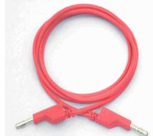
Cavo di misurazione con spina di diametro 4 mm. a entrambe le estremità, molla ingabbiata e presa di diametro 4mm per la costruzione a torre. Molla di contatto in rame berillio placcato nichel. Cavo a trefoli a doppio isolamento, altamente flessibile, a prova di rottura.
