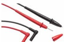
Set di due puntali ad alta robustezza in PVC (rosso e nero) con connettori a banana ad angolo retto; consigliati per le misure di routine. CAT IV a 600 V, CAT III a 1000 V, 10 A, Certificazione UL.
