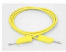
Cavo di misurazione con spina di diametro 4 mm. a entrambe le estremità, molla ingabbiata e presa di diametro 4mm per la costruzione a torre. Molla di contatto in rame berillio placcato nichel. Cavo a trefoli a doppio isolamento, altamente flessibile, a prova di rottura.
