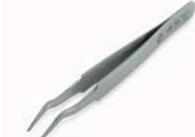
Pinzetta per la manipolazione di componenti in SMD.
