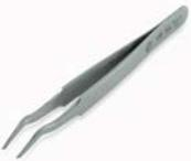
Pinzetta per la manipolazione di componenti in SMD.
