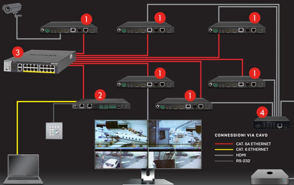
La tecnologia SDVoE all'avanguardia di Lindy offre precisione e affidabilità per gli ambienti di controllo mission-critical. I ricetrasmittitori 4K60 HDMI® e USB SDVoE, insieme al controller SDVoE, garantiscono una distribuzione di contenuti 4K non compressi con supporto HDR, funzionalità multi-view e video wall fino a 9x9.
